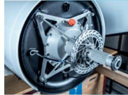
4 moteurs à courant continu sans balais et sans capteurs d'une efficacité exceptionnelle génèrent jusqu'à 13.5 kw chacun. Ils sont munis d'un engrenage de réduction qui limite la rotation d'une hélice bipale de 4 m de diamètre à 525 tours/min. Tout le système offre une efficacité record de 94 %, produisant une perte de 6 % seulement, contre 70 % dans un moteur thermique classique!
