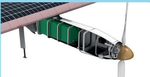
Extrados de l'aile recouvert d'une peau de cellules solaires encapsulées et intrados entoilé d'un film flexible et hautement résistant.
