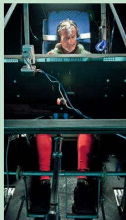
Un simulateur de vol spécialement développé pour Solar Impulse permet d'entraîner les pilotes pour des missions de longue durée et le maniement délicat de leur avion.
